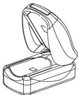
Les circuits numériques de pointe que renferme l'appareil ne nécessitent aucun étalonnage ou maintenance régulière, mis à part le remplacement des piles. La réparation sur site des circuits du 9590 est impossible. N'essayez pas d'ouvrir le boîtier, ni d'en réparer l'électronique. L'ouverture du boîtier endommagera l'appareil et annulera la garantie. N'ouvrez pas le 9590 à plus de 90°, ne tordez pas l'appareil et ne tirez pas dessus pendant que vous le nettoyez.
